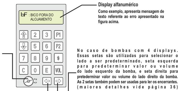
No caso de bombas com 4 displays. Essas setas são utilizadas para selecionar o lado a ser predeterminado, seta esquerda para predeterminar valor ou volume do lado esquerdo da bomba, e seta direita para predeterminar valor ou volume do lado direito da bomba. As 2 setas também podem ser usadas para ler os encerrantes. (maiores detalhes vide página 36)
