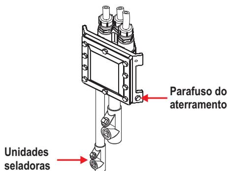
Obs.: Nunca conecte o sistema de aterramento a uma superfície pintada pois haverá isolamento do sistema. Também é recomendado não utilizar a prateleira dos motores para este fim.
