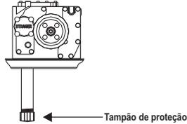
2. Faça o alinhamento da tubulação e conecte o duto de combustível (tubo flexível) à entrada da bomba. Verifique se a junção de segurança encontra-se perfeitamente rosqueada, porém, não aperte totalmente a junção.
