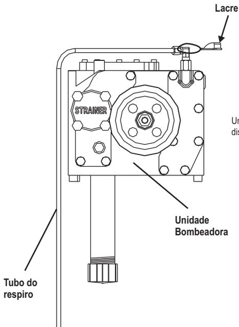
Um lacre na conexão entre a unidade bombeadora e o tubo do dispositivo eliminador de ar e vapores (respiro).
